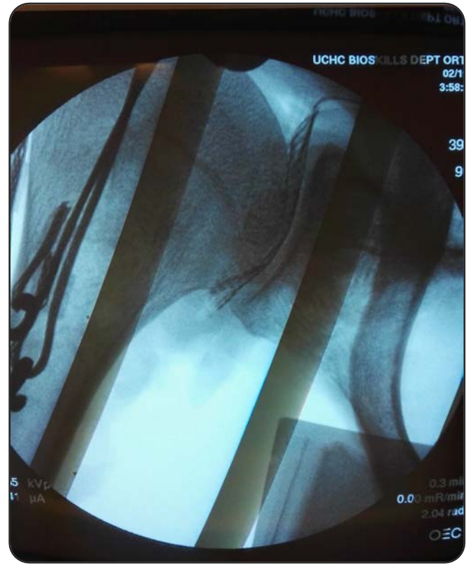
TekScan zwischen Humeruskopf und Glenoidoberfläche
